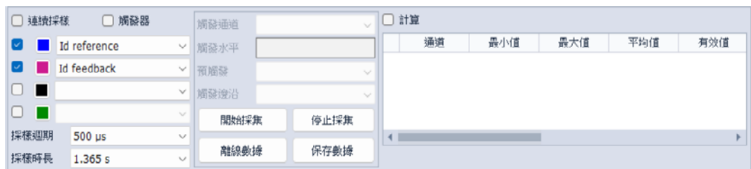
► 圖 4-24 電流環示波器採樣參數設置
