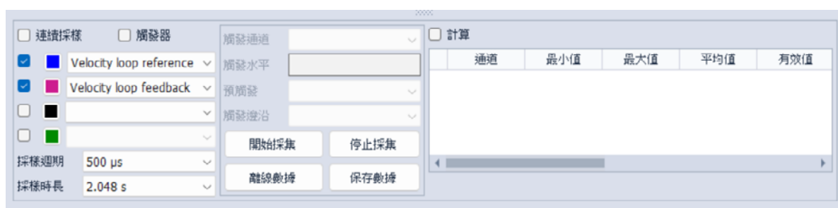
► 圖 4-29 速度環示波器採樣參數設置
